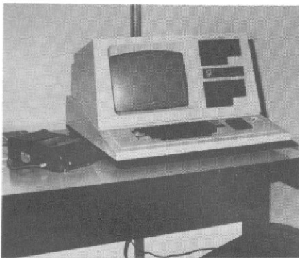
O CP-500 da Prológica, com memória auxiliar opcional (cassete ou disquete de 5"), CPU Z80, 16K RAM e 16K ROM
